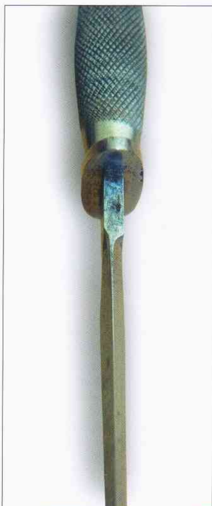
Ungewöhnlich für ein militärisch genutztes Messer: Das 1. Modell entstand zum größten Teil in Handarbeit. Dies zeigt sich besonders am Klingenschliff.
