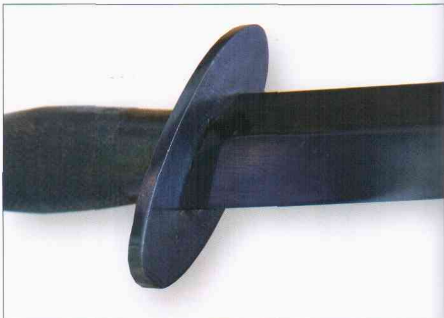
Die vereinfachten Fertigungsmethoden hinterließen ihre Spuren. War die Klinge beim 1. Modell noch makellos in den Griff eingepasst, so zeigen sich beim 2. Modell deutliche Toleranzen.
