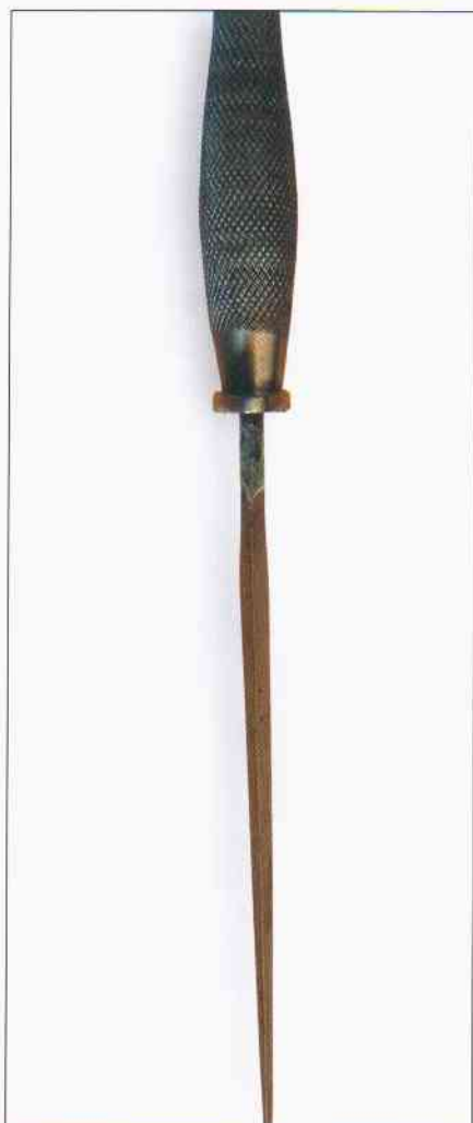
Ungewöhnlich für ein militärisch genutztes Messer: Das 1. Modell entstand zum größten Teil in Handarbeit. Dies zeigt sich besonders am Klingenschliff.
